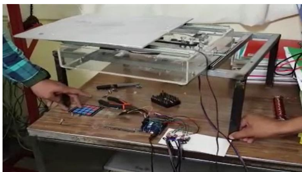
Figura 2 Prototipo de Mesa sísmica usando Arduino y motores paso a paso. Fuente: Los autores
